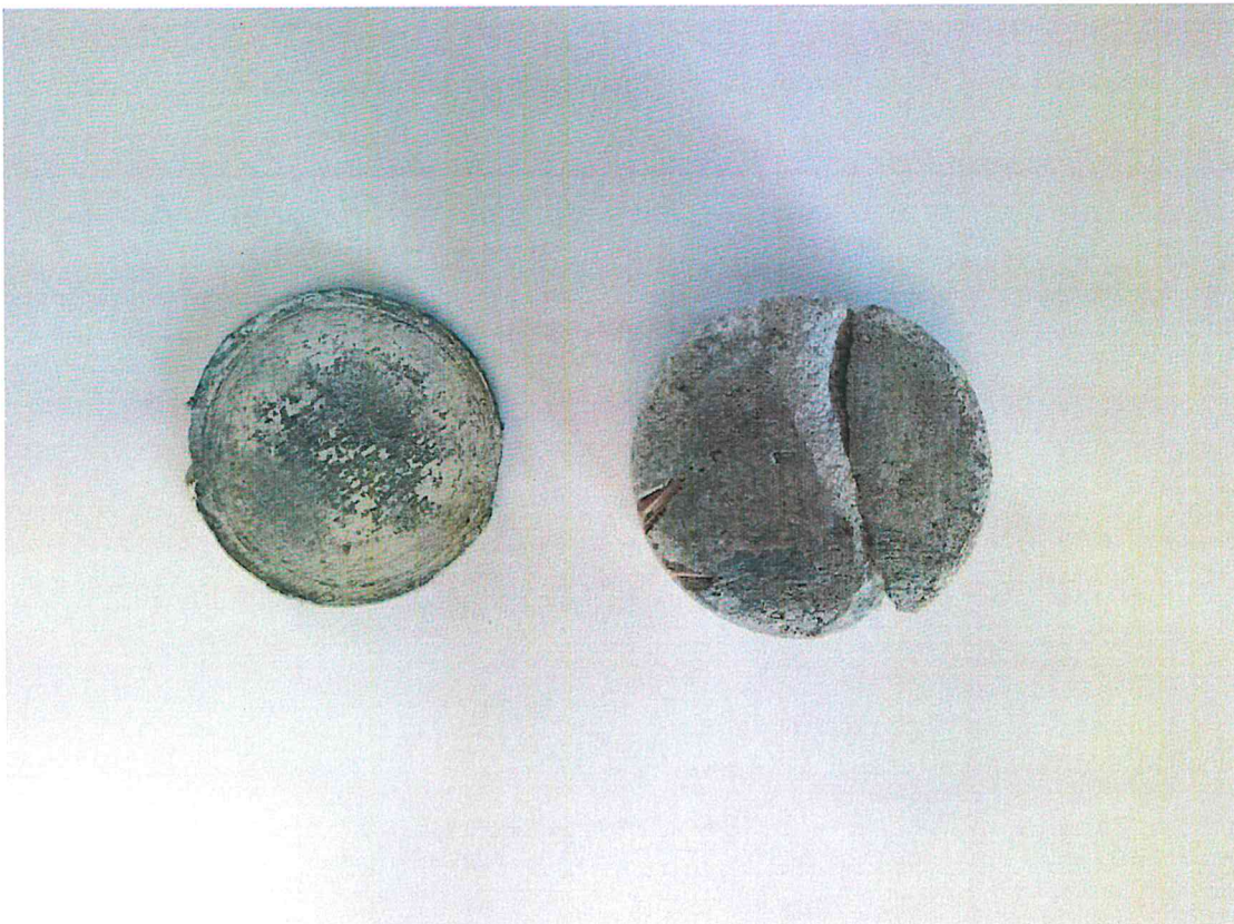
Fot. 5 Rdzeń pobrany z odkrywki nr 2 – element nasączony preparatem na bazie Xylamitu
